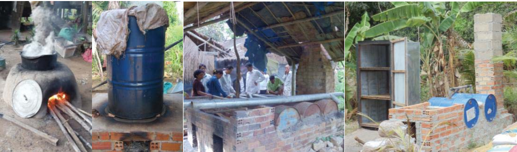
រូបលេខ ៤: ប្រភេទចង្រ្កាន ប្រើសម្រាប់ចំហុយល្បាយបណ្តុះផ្សិតចំបើង
